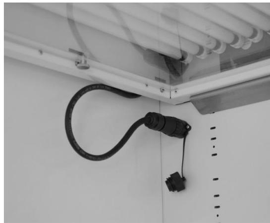
**Figure 2-19**      **Branchement de la fiche du couvercle de lampe du kit de CV**
