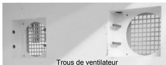
Figure 2-9 Trous de ventilateur et d'entrée d'air du kit de CV
