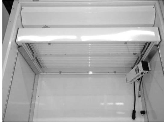
4. Retirez la protection de la prise sous le support de couvercle et branchez la fiche du couvercle dans la prise de la paroi (Figure 2-19).
