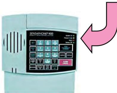
L'appelur automatique réagit à une alarme en faisant de 1 à 4 appels téléphoniques différents. Lorsqu'une personne répond à l'appel, un message « Alert Condition » (condition d'alerte) est envoyé, de même qu'un message vocal enregistré par un utilisateur. La séquence d'appels de l'appelur peut être « reconnue » en tapant « 555 » sur le clavier téléphonique lors de la réception de l'un des appels, ce qui permet d'arrêter la séquence d'appels.
