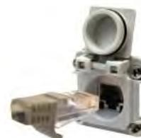
Figure 6.5 : Point de connexion Ethernet sur un contrôleur CMP6000
